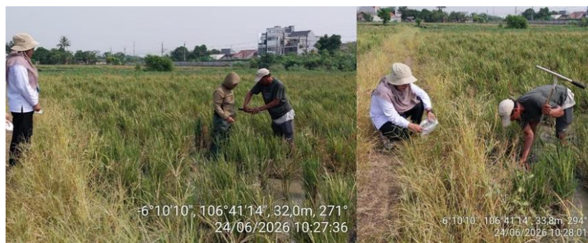
Gambar 2 Proses Pengambilan Sampel Tanah untuk Uji Menggunakan PUTS
